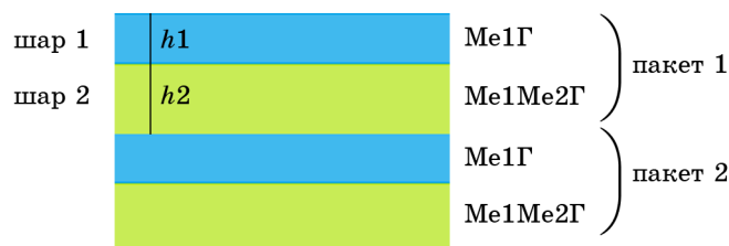
Рис. 7. Схематичне зображення багатошарового покриття, одержаного при роботі пристрою в режимі 1, що складається з двох пакетів (всього 4 шари).
