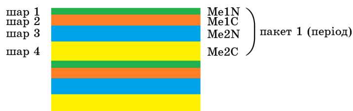
Рис. 2. Схематичне зображення складного комплексного багатошарового вакуумно-дугового покриття, що складається з пакетів (періодів) (\text{Me1N}/\text{Me1C}/\text{Me2N}/\text{Me2C}) .
